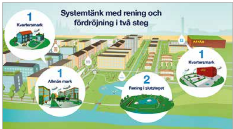
Principskiss över rening och fördröjning i två steg.
