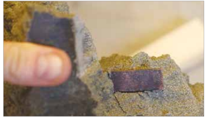
Små bitar av kopparkapslar i bentonitlera för att undersöka korrosion under lång tid. Foto: Daniel Svensson. Källa Ny Teknik
